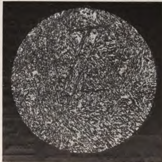
Fig. 149. Werkzeugstahl, abgeschreckt. Martensit.
